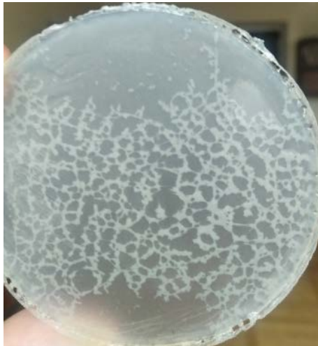
სურ. 3 ბიოდეგრადირებადი კომპონენტის განაწილება მატრიცაში
