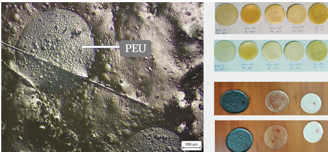
სურ. 2 მიღებული ნიმუშების მორფოლოგია, Zeiss-ის ოპტიკური მიკროსკოპი, x200
