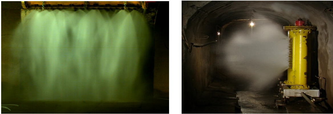
ნახ. 5. წყლის გაფრქვევის პროცესი ჰორიზონტალური (A) და ვერტიკალური აბსორბერებიდან (B)
