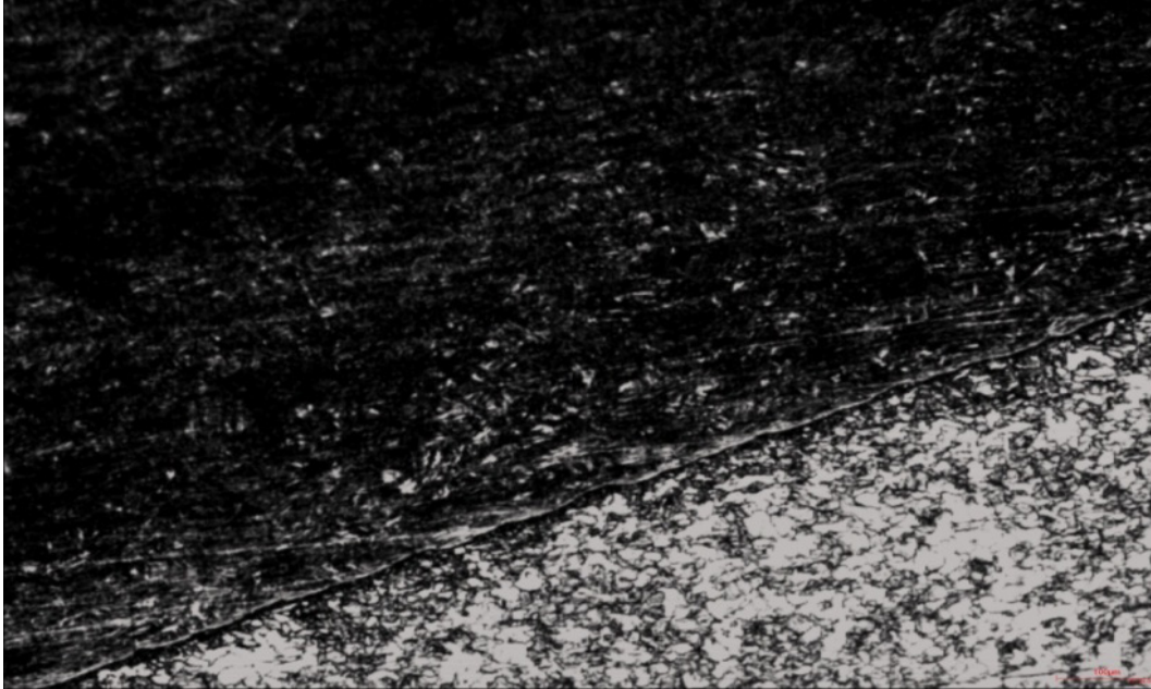
სურ. 5. ლეგირებული ფოლადის და ფოლადი 3-ის შედუღების არე. \dot{\gamma}=50^{\circ}
