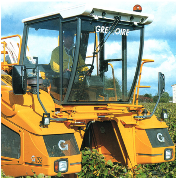
სურ. 151. ეურძნის საკრეფი კომბაინი Optimum (იტალია) ვენახში მუშაობისას
