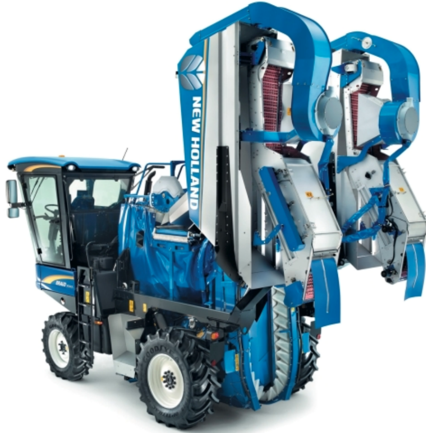
სურ. 148. ყურძნის საკრეფი კომბაინი New Holland Braud 9000L (იტალია)
