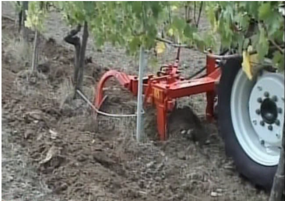
სურ. 134. ვენახის საცავი ზოლების დასამუშავებელი ცალმხრივი მოქმედების მანქანა “Al/15-Rainer” (იტალია). საბრუნო სამუშაო ორგანო მცირე ზომის გუთნის კორპუსი.
