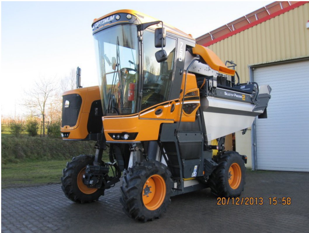
სურ. 150. ეურძნის საკრეფი კომბაინი Optimum (იტალია)
