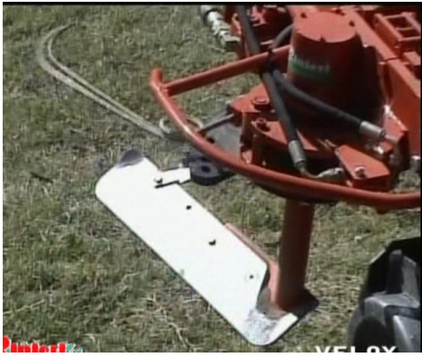
სურ. 133. ვენახის საცავი ზოლების დასამუშავებელი ცალმხრივი მოქმედების მანქანა “Velox 1-Rainer” (იტალია). საბრუნო სამუშაო ორგანო საბრუნო ბრტყლადმჭრელი თათი.
