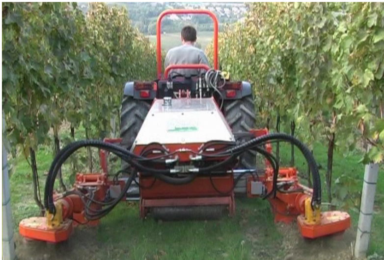
სურ. 136. ვენახის საცავი ზოლების დასამუშავებელი ორმხრივი მოქმედების მანქანა “E-Due-Rainer” (იტალია) საბრუნო სამუშაო ორგანო ვერტიკალურ ღერძიანი ფრეზი.
