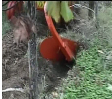
სურ. 134. ვენახის საცავი ზოლების დასამუშავებელი ცალმხრივი მოქმედების მანქანა “Al/15-Rainer” (იტალია). საბრუნო სამუშაო ორგანო მცირე ზომის გუთნის კორპუსი.
