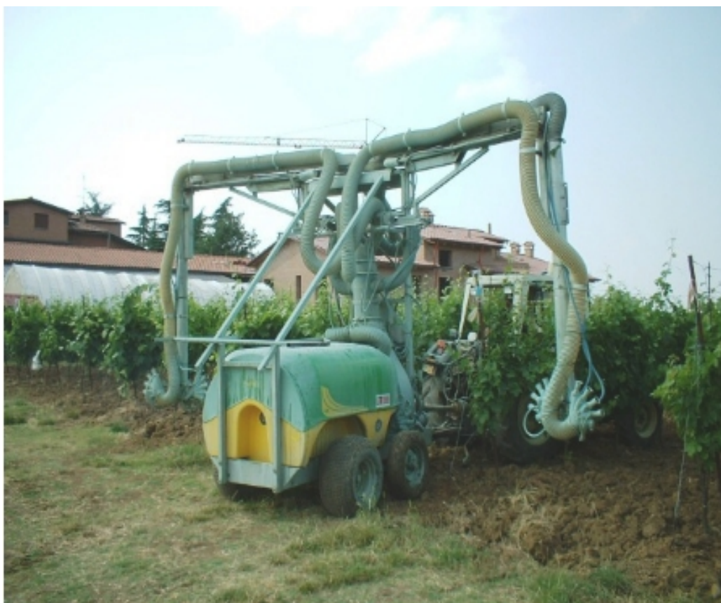
სურ. 140. მცირემოტოლობითი შემსხურებელი "Gamberini-Sprayer- A-133"(იტალია)
