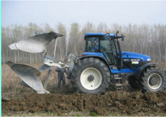
სურ. 129 საპლანტაჟე გუთანი New Holland (იტალია)
