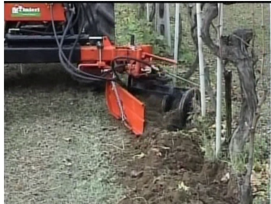
სურ. 135. ვენახის საცავი ზოლების დასამუშავებელი ცალმხრივი მოქმედების მანქანა “Velox 2-Rainer” (იტალია). საბრუნო სამუშაო ორგანო დისკოებიანი იარაღი.
