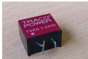
ნახ 50. პლატაზე არსებულ pin კონტაქტებთან მოსარგებლად DC-DC კონვერტორზე გადაღუნულია გამოსასვლელები
