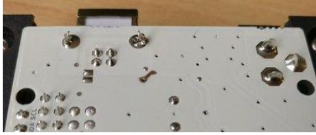
ნახ 55. პლატაზე არსებული 32 პინის გამონათავისუფლება გარდა C7 კონტაქტისა
