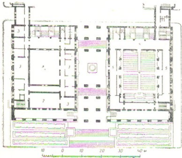
სურ. 13. წინა კორპუსი. მესამე სართულის გეგმა. 1—მინისტრთა საბჭოს ვესტიბიულის ზედა სინათლე, 2—მცირე დარბაზი, 3—კაბინეტები, 4—უმაღლესი საბჭოს დარბაზი, 5—ფოიე.
