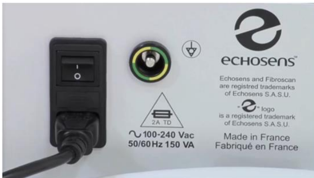
სურ. 9. ულტრაბგერითი ტრანსფორმატორის ელექტრო მახასიათებლები
