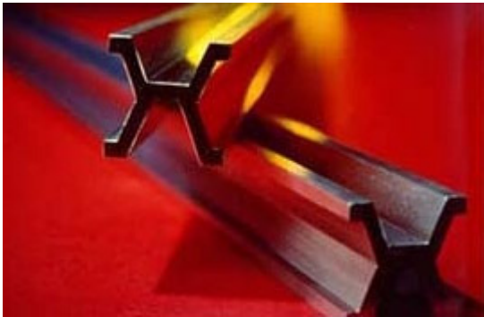
ნახ. 3.7.4. 1889 წლიდან 1960 წლამდე გამოყენებული მეტრის საერთაშორისო ეტალონი
