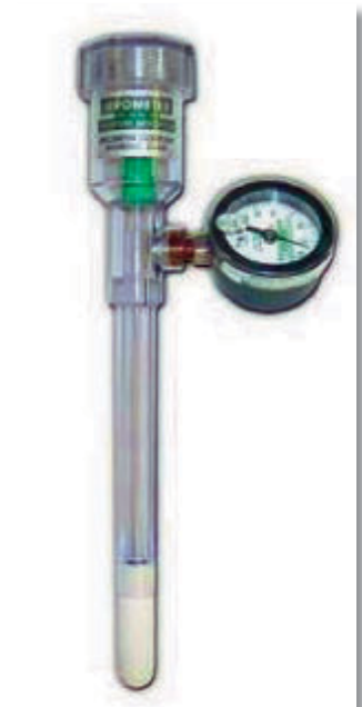
სურათი 31. ტენსიომეტრი ნიადაგის ტენიანობის გასაზომად.
