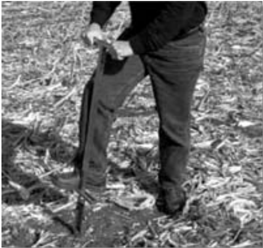
სურათი 6. ნიადაგის ნიმუშის ასაღებად გამოყენებული ინსტრუმენტი.
