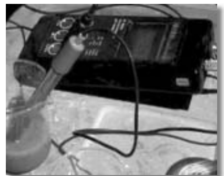
სურათი 7. ნიადაგის pH-ის საზომი პორტატიული აპარატი.
