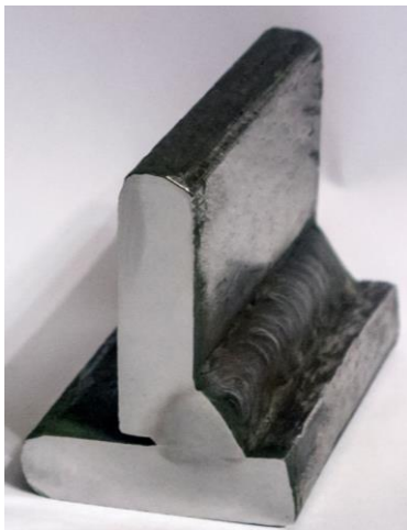
სურ. 6. მეორე სახის ელექტროდით შედუღებული ტესტური შეერთების კუთხური ნაკერების მიკროსახე
