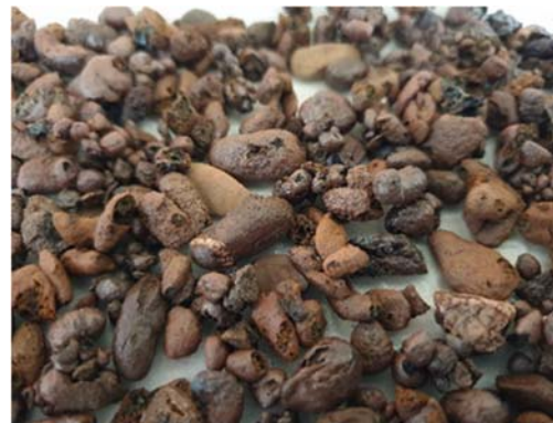
სურ. 6. კერამიტი, მიღებული ყვარლის თიხაფიქლისგან (5–10 მმ)
