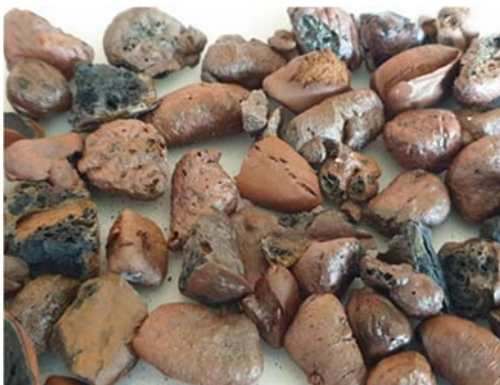
სურ. 7. კერამიტი, მიღებული ყვარლის თიხაფიქლისგან (10–20 მმ)
