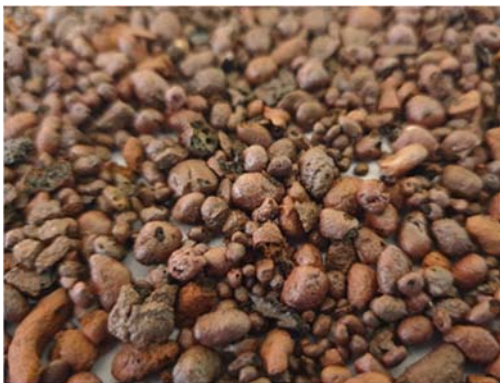
სურ. 5. კერამიტი, მიღებული ყვარლის თიხაფიქლისგან (5 მმ-მდე)
