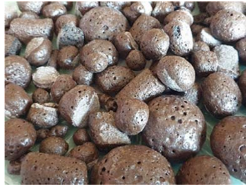
სურ. 4. კერამიტი, მიღებული თელეთის არგილიტისგან (10–20 მმ)
