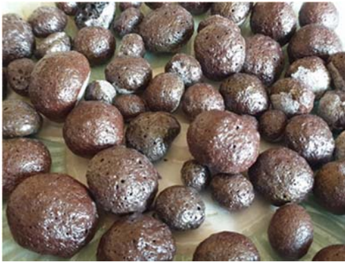
სურ. 3. კერამიტი, მიღებული გარდაბნის თიხისგან (10–20 მმ)
