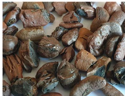
სურ. 8. კერამიტი, მიღებული ყვარლის თიხაფიქლისგან (20–40 მმ)
