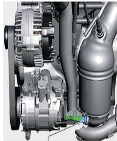
კატალიზატორის წინა ლამბდა ზონდი შემათბობლთან ერთად: მარჯვნივ - კატალიზატორის შემდეგი ლამბდა ზონდი და შემათბობელი
