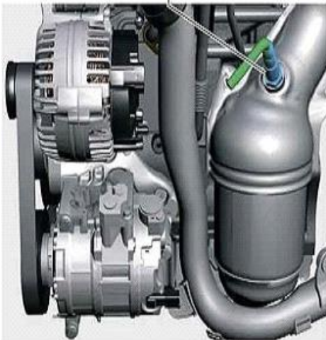
კატალიზატორის წინა ლამბდა ზონდი შემათბობლთან ერთად: მარჯვნივ - კატალიზატორის შემდეგი ლამბდა ზონდი და შემათბობელი
