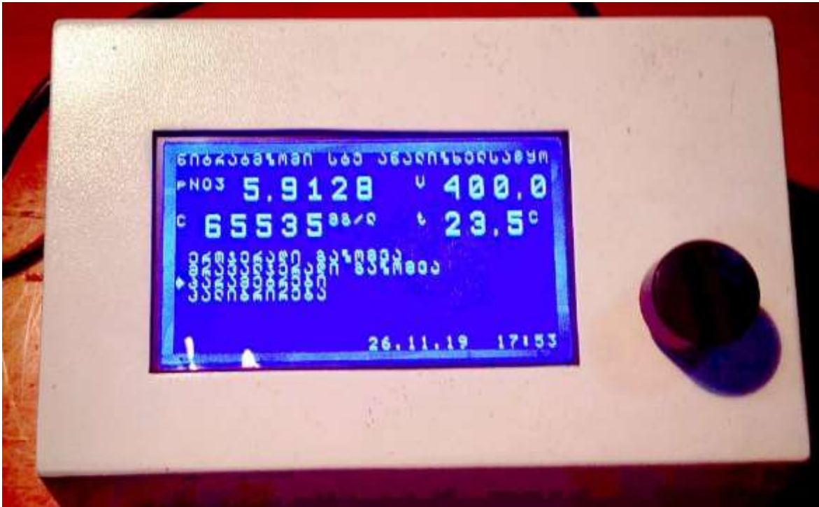
ნახ.2. ნიტრატ-იონების მიკროპროცესორული გამზომი ლაბორატორიული ხელსაწყო
