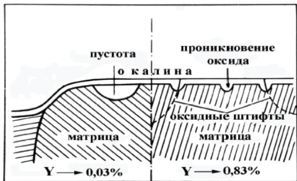
Рис. 4. Схематическое изображение формирования окалины на Fe-Cr-Al-Y сплавах.
