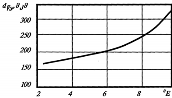
ნახ. 1. წვის კამერაში გაფრქვეული ძველი დიზელის საწვავის წვეთების საშუალო დიამეტრის დამოკიდებულება პირობითი სიბლანტეზე (°E)
