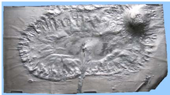
Рис. 8. След реактивной диффузии никелевого покрытия с алюминиевой подложкой. Температура конденсации 380-460°C.
