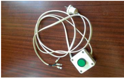
სურ. 5. საყოფაცხოვრებო მაცივრის დგუშიანი კომპრესორის სადიაგნოსტიკო ინოვაციური მოდულატორის ხედი
