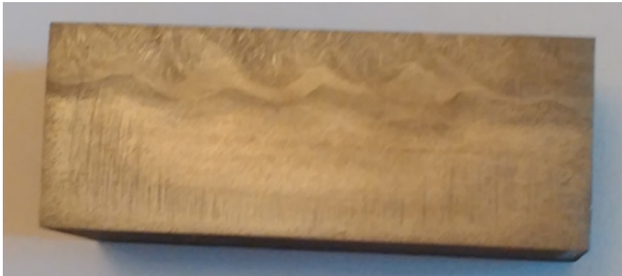
Рис.2. Образец без трещин после пластической деформации.
