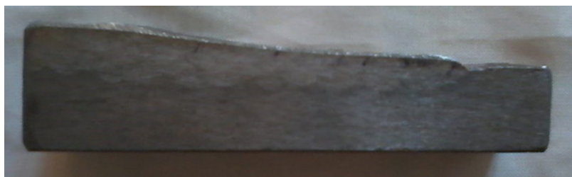
Рис.1. Количество трещин и их размеры при двухслойной наплавке стали.
