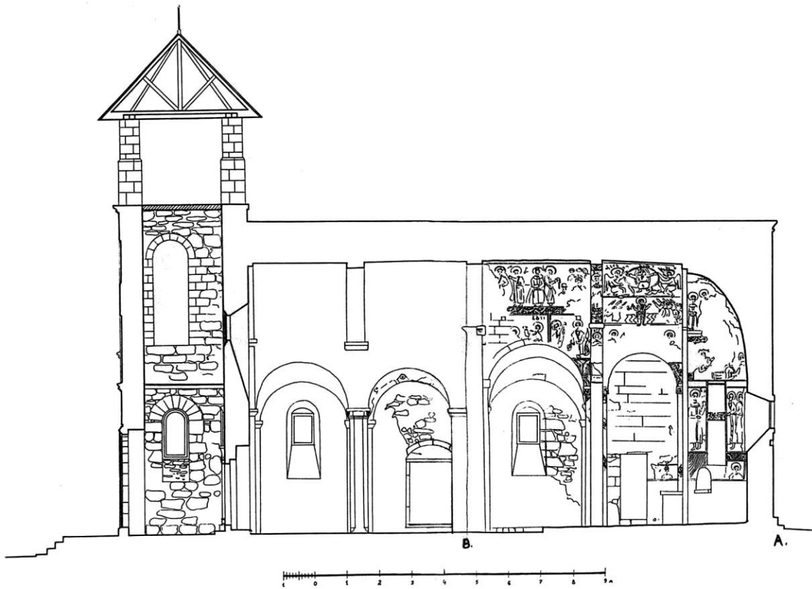
ნახ. IV. (რუკ. IV). წვეის წმ. გიორგის ბაზილიკის განაკვეთი სივრძეზე, ხელი ჩრდილოეთისაკენ. A-B-თი აღნიშნულია ეკლესიის თავდაპირველი ნაგებობა
