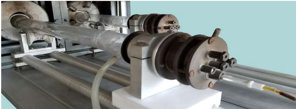
ნახ.1. თხევად-ფაზური ეპიტაქსიის LPE მეთოდით კრისტალების გასაზრდელად აწყობილი ლაბორატორიული დანადგარის რეაქტორი
