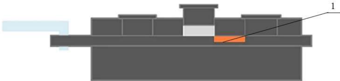
ნახ.3. თხევადი ეპიტაქსიის ჩასატარებლად დამზადებული კასეტის განივი ჭრილი
