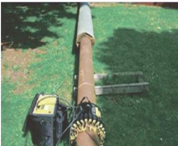
ნახ. 2. FOCUS TELE TEST – მოწყობილობით მუშაობის პრინციპი
