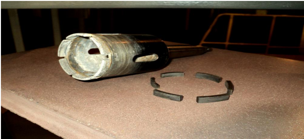
სურ. 2. სეგმენტებიანი ალმასური ბურღის კონსტრუქცია და მისი მჭრელი ელემენტები
