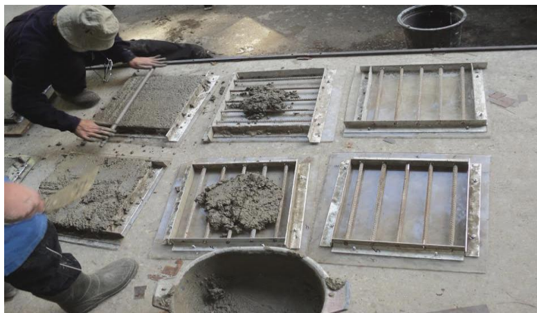
სურ.1. რკინა-ბეტონისა ფილების დამზადების ოპერაცია
