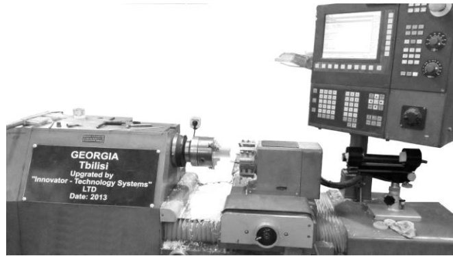
სურ. 1. სახარატო ჩარხი TTK-125 SIEMENS-ის პროგრამული მართვის სისტემით
