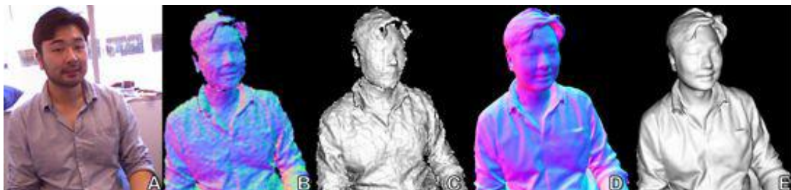
ნახ. 3. Kinect Fusion: ა) RGB გამოსახულება; ბ) და გ) ნორმალეები და სამგანზომილებიანი ბაღე ერთი სიღრმისეული რუკიდან; დ) და ე) შერეული TSDF-დან მიღებული სამგანზომილებიანი მოდელი.
