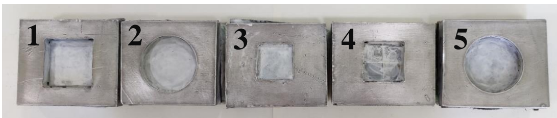
სურ. 18. ბალისტიკური ტესტირებისათვის მომზადებული ჯავშან ფილები: 1- TiB_2-TiC-Ni , 2- B_4C-SiC , 3- TiB_2-TiC-SiC-FeNi , 4- TiB_2-TiC-SiC-FeNi , 5- TiB_2-TiC-SiC-Al_4SiC_4
