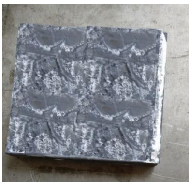
სურ. 13. აწყობილი საჯავშნე ფილა TiB_2-TiC-SiC-FeN
