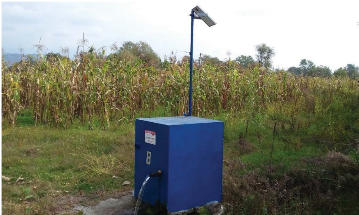
სურ.26. ჰიდროგეოლოგიური მონიტორინგის ქსელის ავტომატური სადგური
