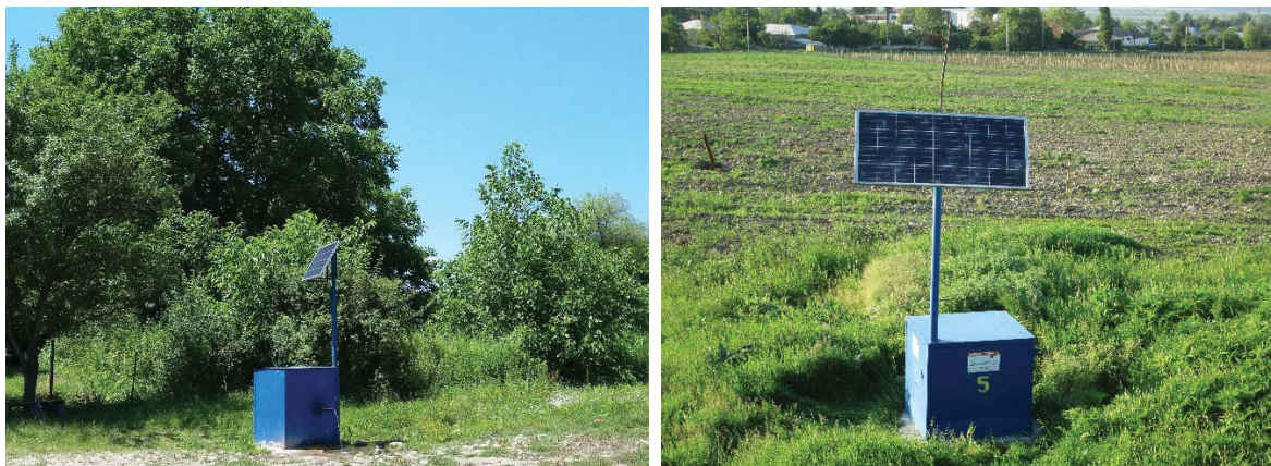
სურ.27-28. ჰიდროგეოლოგიური მონიტორინგის ქსელის ავტომატური სადგურები
