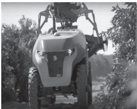
სურ. 7. რობოტ-შემსხურებელი „Jacto Arbus 4000 iav“, რომელიც აღჭურვილია 132 ცხ.დ დიზელის ძრავით. ავზი შესასხურებელი სითხისთვის იტევს 4000 ლიტრს
