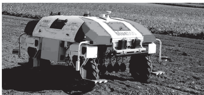
სურ. 6. ახალი საველე რობოტი „Bluebod“, რომლის დანიშნულებაცაა შაქრის ჭარხლის მოვლა-მოყვანის პროცესის ავტომატიზაცია
