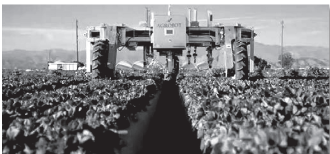
სურ. 5. აგრორობოტი, რომლის დანიშნულებაცაა მარწყვის მოსავლის აღება, მას გააჩნია 24 რობოტიზირებული მანიპულიატორი
