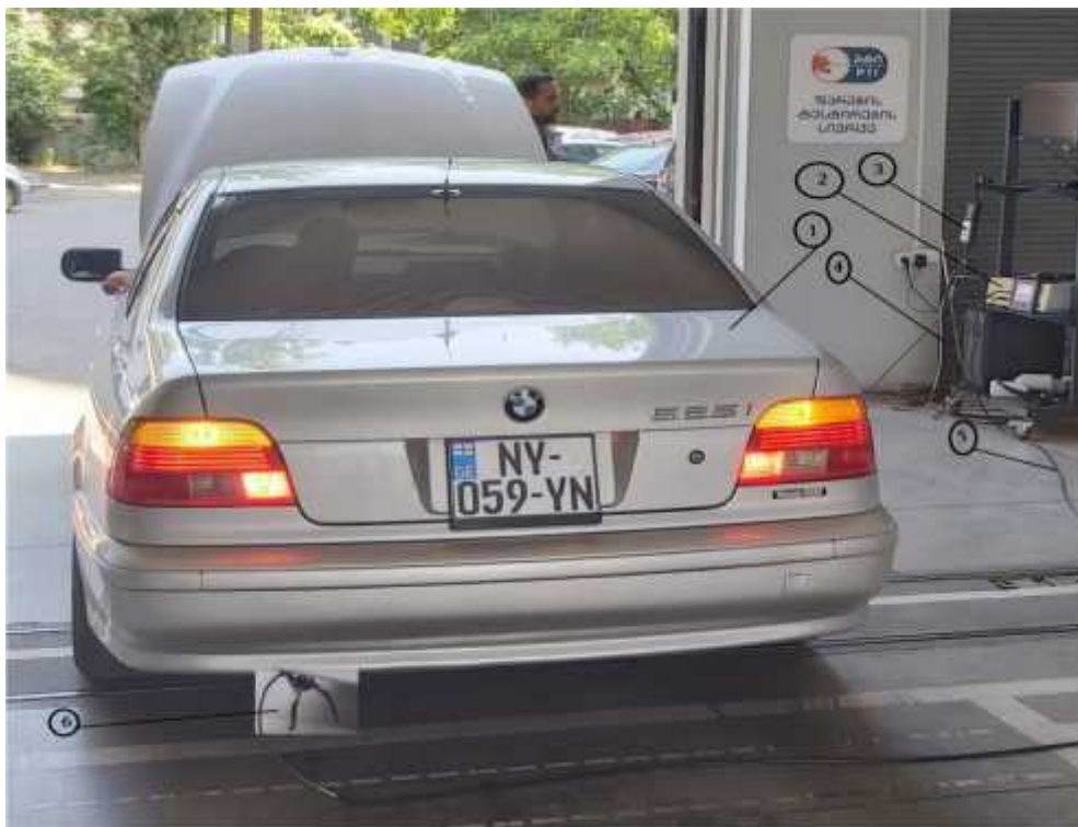
ნახ.2.1.9 BMW მარკის ავტომობილის ტესტირება გამონაბოლქვში CO -ს შემცველობაზე, ტექნიკური ინსპექტირების ცენტრში - „ჭაპანი“ .
