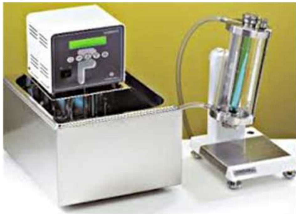
ნახ.2.1.2. ხელსაწყო კინემატიკური სიბლანტის განსაზღვრისთვის
