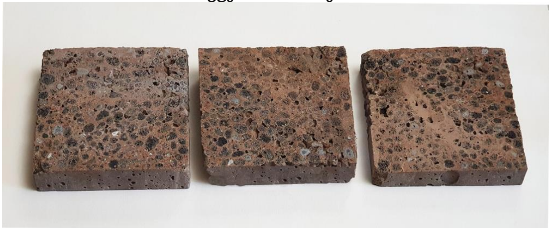
სურათი 19. კერამზიტბეტონი №2 - კერამზიტი მიღებული ყვარლის თიხაფიქალის აფუებით 1190 °C-ზე
