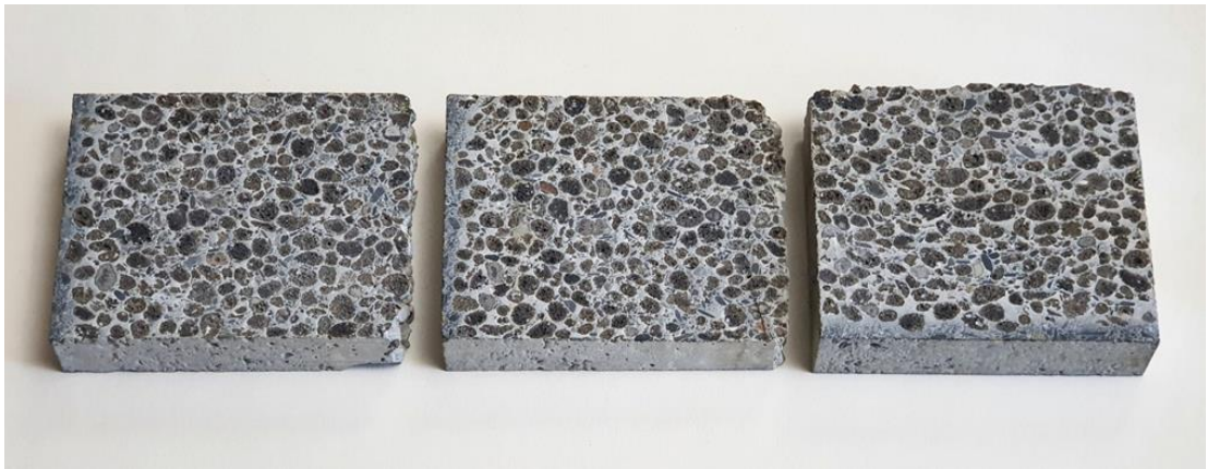
სურათი 18. კერამზიტბეტონი №1 - კერამზიტი მიღებულია გარდაბნის თიხის აფუებით 1180 °C -ზე
