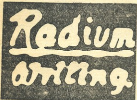
წარწერა ფოტოგრაფიულ ფირფიტაზე, გაკეთებულ პატარა მინის მილით, რომელშიც რადიუმის მარილი იყო მოთავსებული.
