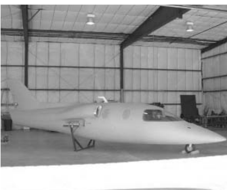
სკორტ-ჯეტი - მთლიანად შუშა-კარბონის ქსოვილისა და პოლიეთერული ფისების კომპოზიციური მასალისგან მზადდება და აქვს ერთადერთი ტურბორეაქტორული ძრავა (პრატენდ უიჯინის, ან უილიამს ინტერნიშნლის ნარმოებისა), რომელიც ფიზიკალურად უკანა მიერთებულია.
