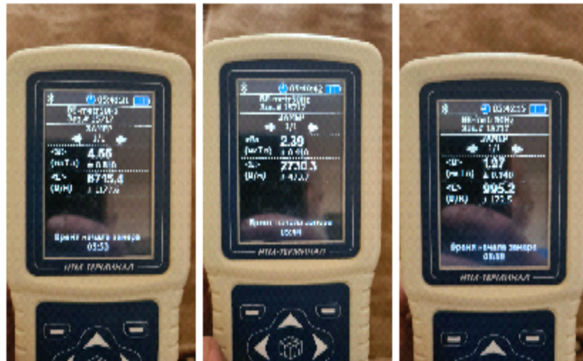
ნახ.6. 220 კვ საჰაერო ელექტროგადაცემის ხაზის მაგნიტური ველი დაძაბულობის გაზომვის შედეგები: ა) კიდურა ხაზის ქვეშ; ბ) კიდურა ხაზის გეგმილიდან 10 მ-ს დაშორებით; გ) კიდურა ხაზის გეგმილიდან 20 მ-ის დაშორებით
