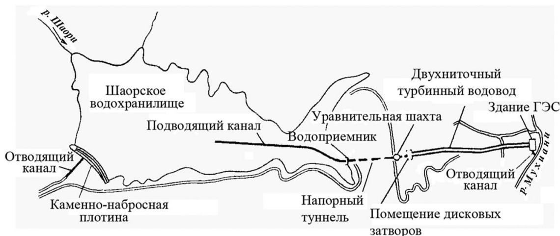
Рис. 1.3.3.7. Схема расположения гидросооружений Шаорской водохранилищной системы 1 – водоотводной канал; 2 – каменно-набросная плотина с глиняным экраном; 3 – подводящий канал; 4 – напорный тоннель; 5 – помещение дисковых затворов; 6 – отводной канал; 7 – здание ГЭС; 8 – водовод; 9 – уравнительная шахта; 10 – водоприемник.
