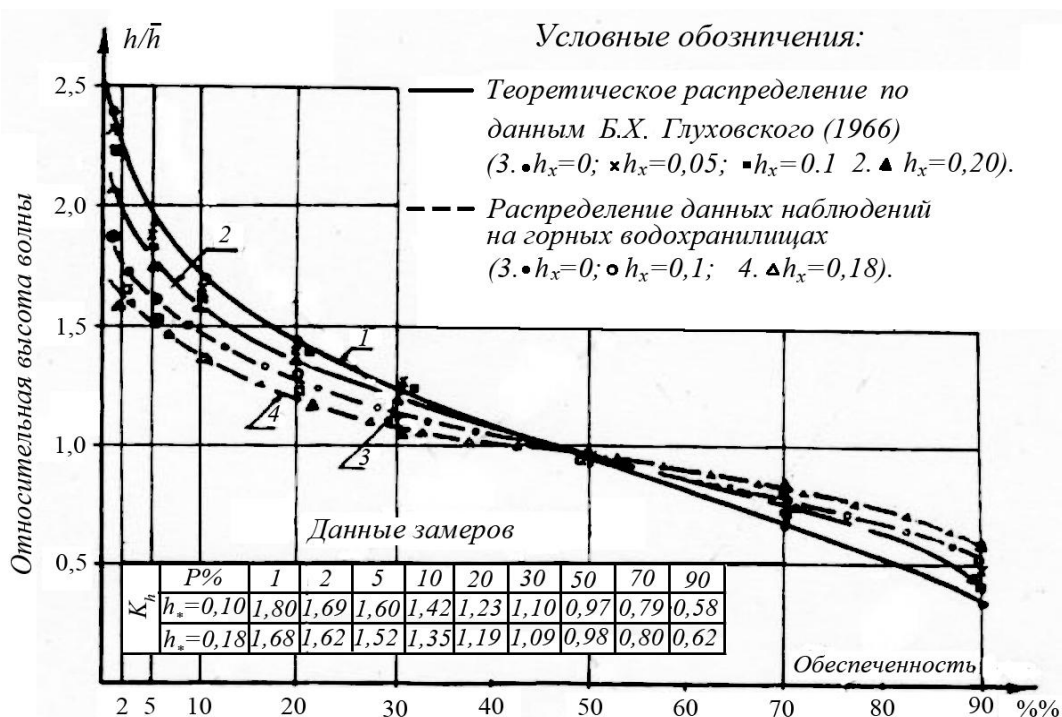
Рис. III.1.3. Изменение распределения относительных высот волн с изменением относительной глубины в месте замеров (средненные данные). Обозначение: h_x = h / H
