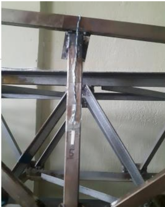
სურ. 41 კონსტრუქციაზე დამაგრებული სენსორული გადამწოდები
