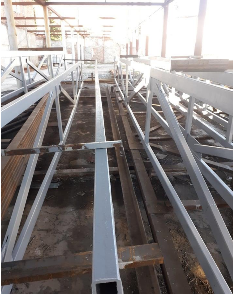
სურ.32. სწორად შესრულებული შედულებით აკრებილი კონსტრუქცია
