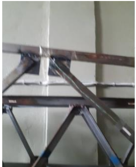
სურ. 41 კონსტრუქციაზე დამაგრებული სენსორული გადამწოდები
