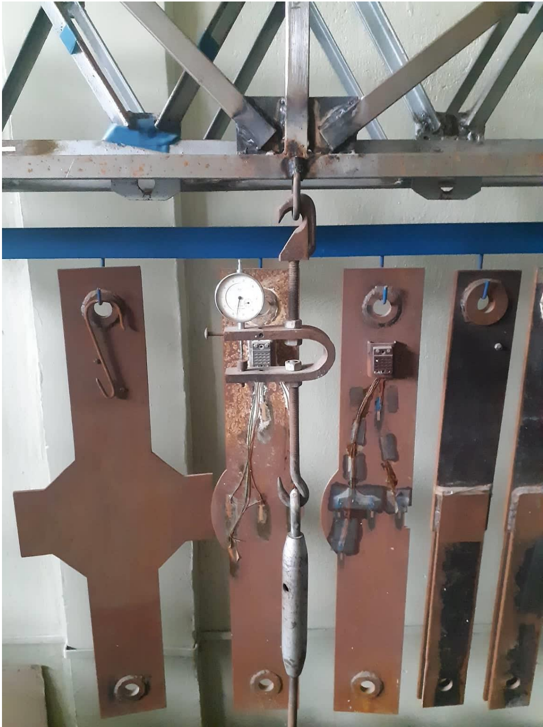
სურათი 42 კონსტრუქციის მაკეტზე მოდებული დატვირთვა
