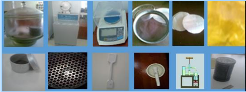
სურ. 4.5.5. მასალები და მოწყობილობები: სასწორი; ვაკუუმსაცხი; ექსიკატორი; ალუმინის ჭიქა სახურავით, საშრობი კარადა, თერმოსტატი, საცერი 1 მმ, ტილოს ნაჭერი, ლითონის ნასვრეტებიანი ფირფიტა, ფილტრის ქაღალდი.
