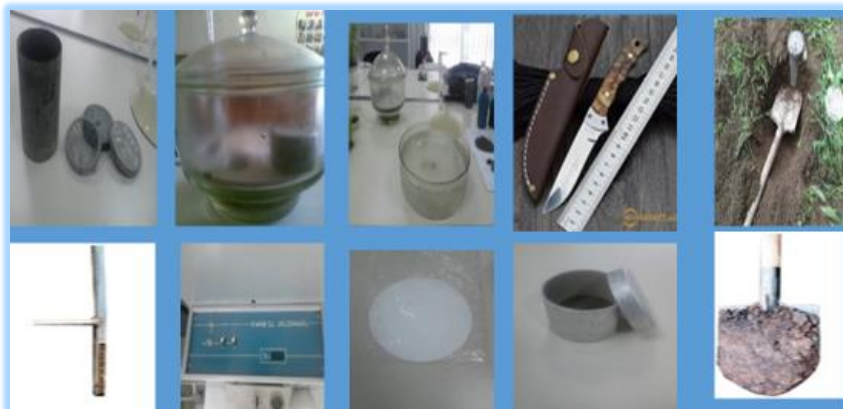
სურ. 4.7.1. ნიადაგის ზღვრული ტენტევადობის განსაზღვრისათვის საჭირო მასალები და მოწყობილობები: სასწორი, ცილინდრი ბადით, ექსიკატორი, წყლის აბაზანა, დანა, ლუმინის ჭიქა, ფილტრის ქაღალდი, სასწორი, თერმოსტატი, ბურღი, ბარი
