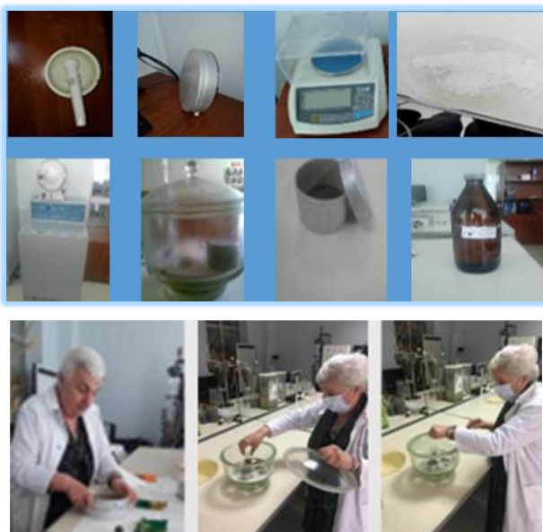
სურ.4.6.1. ნიადაგის მაქსიმალურ ჰიგროსკოპიული ტენის განსაზღვრის საჭირო მასალები და მოწყობილობები: სასწორი, ვაკუუმ საცხი, ექსიკატორი, ალუმინის ჭიქა, თერმოსტატი, გოგირდმჟავა, საცერი 1 მმ, როდინი.
