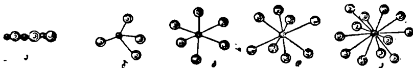
ნახ. 16. ატომთა და იონთა კოორდინაციის (ერთიერთგარშემოკერის) რამდენიმე შემთხვევა. ა—მოლუწულური ჯაჭვი (პანტელი); კოორდინაციული რიცხვი უდრის 2-ს; ბ—ტეტრაედრული (4); გ—ოქტაედრული (6); დ—კუბური (8); ე—დვიდროესი კუბური წეობა (12).
