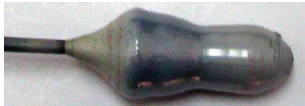
ნახ.6.13. მეტალურგიული სილიციუმის ნადნობიდან 0.3 მმ/წთ სიჩქარით ორჯერ ამონევით მიღებული სილიციუმის კრისტალი
