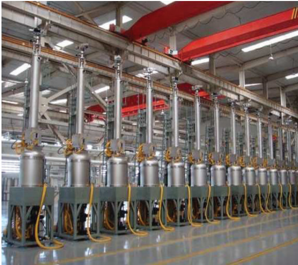
ნახ.5.9. „მონო“ სილიციუმის მიღება ჩოხრალსკის მეთოდით წარმოებაში (ECM GREENTECH)
