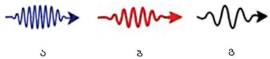
ნახ. 9.2. „ტალღური პაკეტი“: ა) მაღალი ენერგიის ფოტონი ცისფერი სინათლისთვის; ბ) დაბალი ენერგიის ფოტონი წითელი შუქისთვის; გ) დაბალი ენერგიის ფოტონი ინფრანითელი სხივებისთვის
