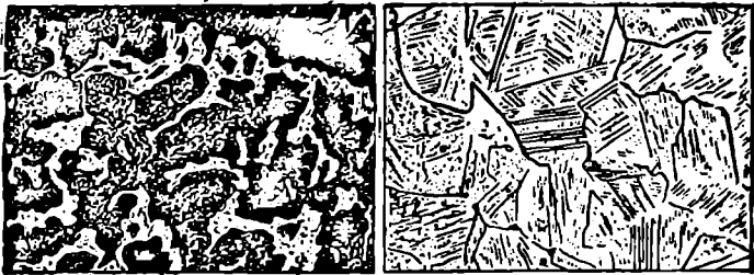
ნახ. 79. კალიანი ბრინჯაო (Sn=6%), ა — სხმული; ბ — ჩამოსხმის შემდეგ დეფორმირებულა და მომწეარი X250
