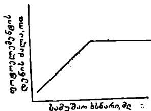
ნახ. 101. ფოტოელემენტის დენის ძალის ცვლილება ფოტონეფლომეტრიული გატიტრის დროს.
