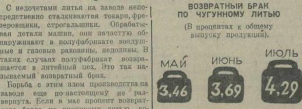
С недочетами лития на заводе непосредственно сталкиваются токари, фрезеровщики, строгальщики. Обрабатывая детали машин, они зачастую обнаруживают в полуфабрикатах воздушные и газовые раковины, недочеты. В таких случаях полуфабрикат возвращается в литейный цех. Это так называемый возвратный брак.
