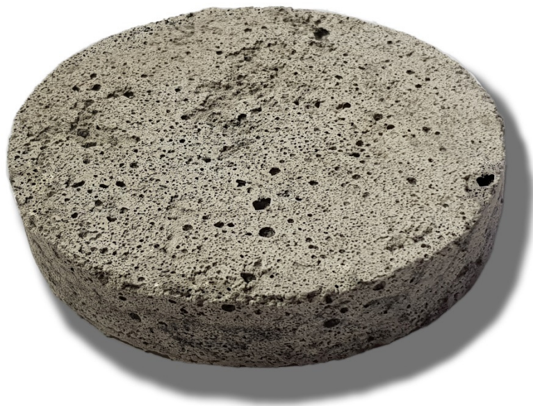
სურათი 3. გეოპოლიმერული მჭიდა მასალა ნაყარი წიდის, ქვიშისა და ფოსფორმჟავას საფუძველზე (ნიმუში # 8).
