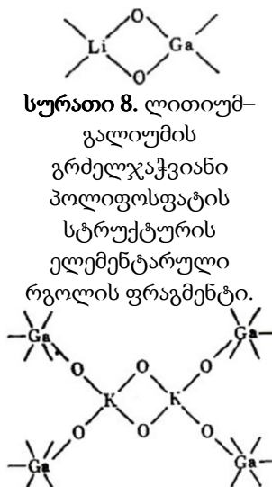
სურათი 8. ლითიუმ-გალიუმის გრძელჯაჭვიანი პოლიფოსფატის სტრუქტურის ელემენტარული რგოლის ფრაგმენტი.
