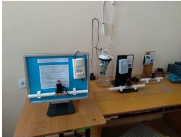
ნახ. 2. გაზის გაუონვის დეტექტორის გამოცდის სტენდი (სტუ-ს ავტომატიზაციის ცენტრში დამზადებული)
