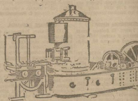
Кирпичеделательная машина, изобретенная батумским слесарем т. Коноваловым. Машина выбрасывает 150-0 кирпичей-сырца в течение 8-часового рабочего дня при трех рабочих.
