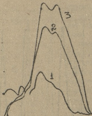
Рис.3. Фурье-ИК-спектр полиимидной пленки в области 400-300 \text{см}^{-1} в норме /1/ и при биодеградации полимера без/3/ и в присутствии маннитола /2/.
