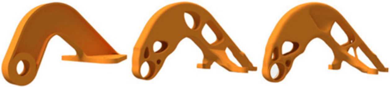
სურ. 1 ტოპოლოგიურად ოპტიმიზებული სამაგრი
