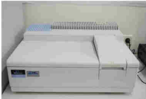
იწ-სპექტრომეტრი ფურიე-გარდაქმნით – Spectrum One. გაზომვა ეფუძნება ინფრაწითელი გამოსხივების შთანქმას საკვლევი ნიმუშის მოლეკულებით.
