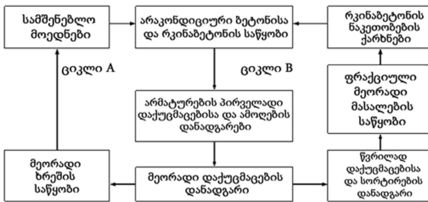
ნახაზი. 2. არაკონდიციური ბეტონისა და რკინაბეტონის ნარჩენების დამუშავებისა და გამოყენების სქემა.
