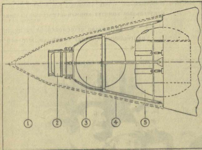
СХЕМА РАЗМЕЩЕНИЯ АППАРАТУРЫ: 1. Защитный конус, сбрасываемый после выведения спутника на орбиту. 2. Прибор для исследования ультрафиолетового и рентгеновского излучения Солнца. 3. Сферический контейнер с аппаратурой и радиопередатчиками. 4. Силосная рама для крепления аппаратуры. 5. Герметическая кабина с подопытным животным.
