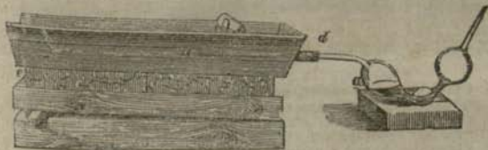
Фиг. 93. Способъ выдѣленія амміака изъ азотистыхъ органическихъ веществъ. Смѣсь такого вещества съ натристой известью кладутъ въ трубку, которую нагрѣваютъ на жаровнѣ. Выдѣляется смѣсь паровъ и газовъ. Ихъ пропускаютъ въ сосудъ a , содержащій воду или кислоту. Въ нихъ растворяется амміачный газъ.
