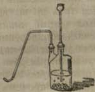
Фиг. 53. Двугорлая стеклянка съ цинкомъ и сѣрною кислотой для полученія водорода. Такой приборъ употребляется во всѣхъ случаяхъ, когда отдѣляется газъ при дѣйствіи жидкости на твердое тѣло и при обыкновенной температурѣ.
