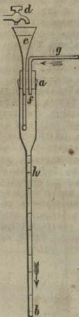
Фиг. 58. Аспираторъ, дѣйствующій постоянно. Трубка h должна быть длинная \frac{1}{2} .
