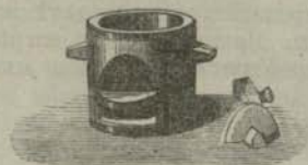
Фиг. 120. Глиняная жаровня, употребляемая въ лабораторіяхъ, для нагреванія углемъ, лежащимъ на рѣшеткѣ. \frac{1}{2} .
