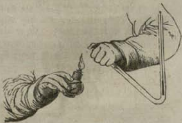
Фиг. 45. Испытаніе горючести водорода, собраннаго при разложеніи воды гальваническимъ токомъ 1/12 .
