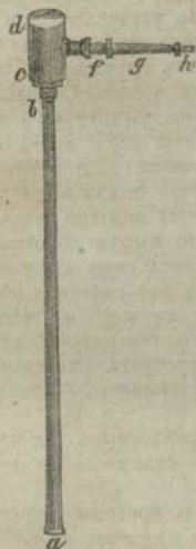
Фиг. 128. Пальная трубка. Черезъ a вдувается ртомъ воздухъ, черезъ платиновый наконечникъ h онъ входитъ въ пламя. Барабанъ cd служитъ для соединенія вставленныхъ въ него трубокъ ab и fg . \frac{1}{2} .
