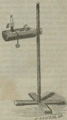
Фиг. 129. Масляная лампа, употребляемая для пальной трубки. Въ пламя ея вставляется конецъ пальной трубки. \frac{1}{2} .
