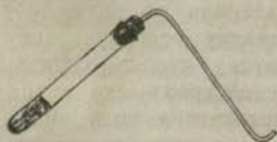
Фиг. 75. Пробирный цилиндръ для полученія кислорода изъ бертолетовой соли. \frac{1}{2} .
