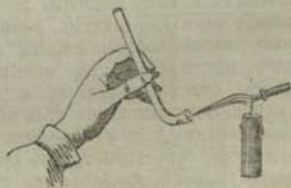
Фиг. 133. Нагрѣваніе въ пламени паяльной трубки предмета, лежащаго въ стеклянной трубкѣ, для испытанія его горючести.
