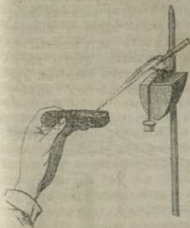
Фиг. 130. Нагрѣваніе на углѣ въ пламени паяльной трубки. \frac{1}{5} .
