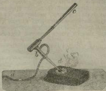
Фиг. 131. Нагрѣваніе на углѣ съ помощью весьма удобной газовой паяльной трубки, въ которую газъ доставляется трубкою ab . \frac{1}{4} .
