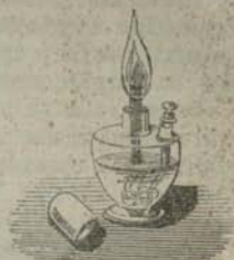
Фиг. 121. Обыкновенная стеклянная спиртовая лампа, съ пробкой для вливанія спирта и колпачкомъ для тушенія. \frac{1}{10} .
