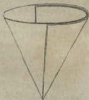
Фиг. 34. Кружокъ, вырѣзанный изъ неклееной или пропускной бумаги и сложенный въ четыре раза для погруженія въ воронку, служащую для процеживанія.
