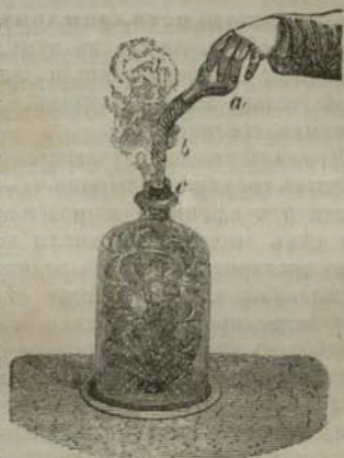
Фиг. 147. Горѣніе порошка сурьмы въ хлорѣ сопровождается свѣтомъ и образованіемъ удушливой SbCl_3 . Чтобы уменьшить выдѣленіе ея, сурьму насыпаютъ въ колбу a , надъ ваютъ каучукъ b и соединяютъ его съ пробкою c сосуда, содержащаго хлоръ. \uparrow ю
