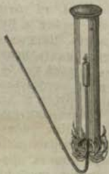
Фиг. 67. Свѣча зажигаетъ водородъ, но въ немъ тухнетъ.
