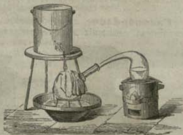
Фиг. 25. — Перегонка въ нетубулатной ретортѣ, горло которой вставлено прямо въ приемникъ, охлаждаемый струею воды.
