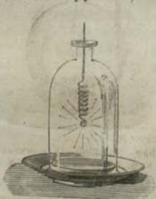
Фиг. 77. Способъ сжиганія стальной пружины въ кислородѣ. 1/18 .
