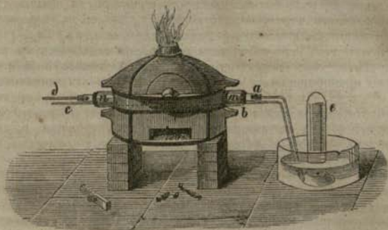
Фиг. 50. Разложеніе воды дѣйствіемъ жара и отдѣленіе образующагося водорода съ помощью просачиванія чрезъ пористую трубку. \frac{1}{10} .
