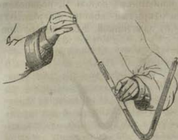
Фиг. 46. Испытаніе съ помощію горящаго тѣла кислорода, полученнаго при разложеніи воды гальваническимъ токомъ \frac{1}{12} .
