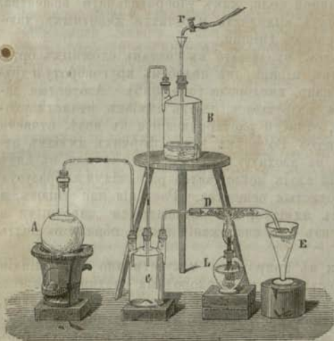
Фиг. 101. Способъ превращенія амміака, получаемого въ (А) при дѣйствіи воздуха (выдѣляется изъ В) и губчатой платины (нагрѣваемой въ С) въ азотную кислоту. \frac{1}{12} .
