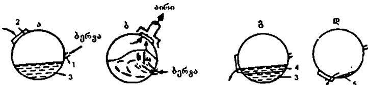
სურ. II.12. პორიზონტალური ტიპის კონვერტერის პოზიციები სხვადასხვა ოპერაციების დროს. ა. თხევადი შტეინის ჩასხმა; ბ. შტეინში ბერვა (მუშა პოზიცია); გ. კონვერტერული წიფის გადმოსხმა; დ. პროდუქტის გადმოსხმა.
