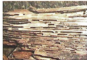
ნახ. 1.64. წითელმკერდა ჭიანჭველას მიერ დაზიანებული მერქანი.
