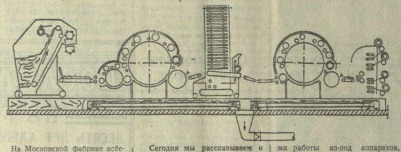
На Московской фабрике асбестовых изделий разработан механизированный поточно-непрерывный процесс выработки ровницы. Он позволил значительно усовершенствовать средства транспортировки отходов произ-
